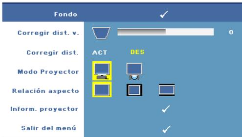
**CORREGIR DIST. V.**—Le permite ajustar la distorsión de la imagen causada al inclinar el proyector.
