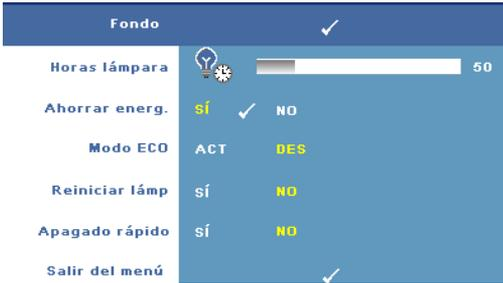
**HORAS LÁMPARA**—Muestra las horas de uso desde el restablecimiento del temporizador de la lámpara.
